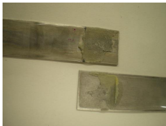
Figura 4.- Rotura adhesiva-cohesiva entre PP Goodfellow-Al (tratado).
