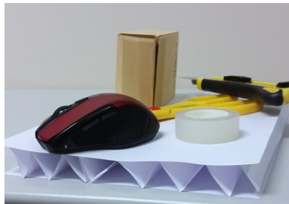
Figura 6. Utilizando folios y un poco de cinta adhesiva se pueden crear estructuras con alta rigidez específica.
