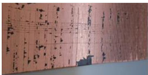
Figura 3. Panel ensayado a adhesión bajo la norma ISO 2409:1994 sin mejora superficial.
