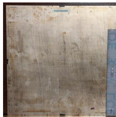
Figura 1. Primeras pruebas de metalización de cobre por evaporación térmica sobre material compuesto.
