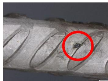
**Figura 7.** Detalle de la corrosión encontrada en la barra E11.
