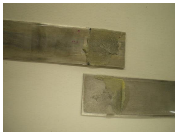
Figura 4.- Rotura adhesiva-cohesiva entre PP Goodfellow-Al (tratado).
