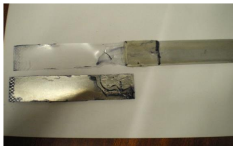
Figura 1.- Deformación del Film PP-Goodfellow bajo tracción-cizalla.
