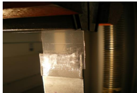
Figura 2.- Deslizamiento del PP-Goodfellow (tratado) adherido mediante adhesivo doble cara RP-45 al realizar el ensayo de tracción-cizalla.
