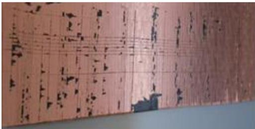
**Figura 3.** Panel ensayado a adhesión bajo la norma ISO 2409:1994 sin mejora superficial.
