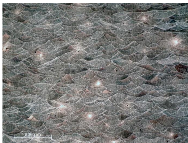
Figura 4. Micrografía óptica de la aleación Al10Si1Mg-FA realizada en el grupo CCRM-UCM.
