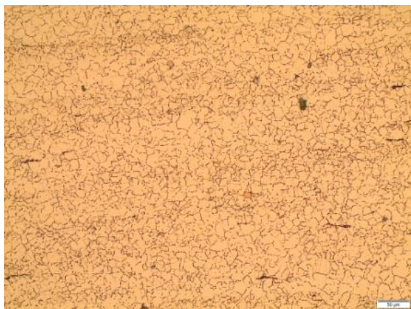
Figura 2. Material torsionado a 4\text{s}^{-1} , 1200°C.
