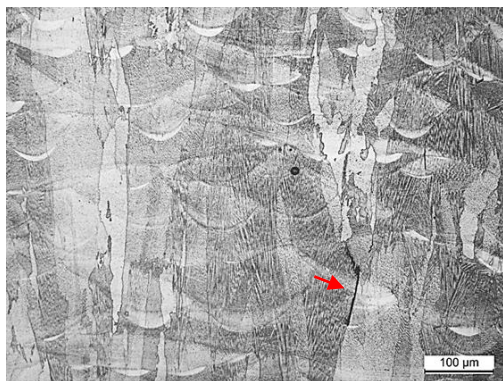
Figura 6. Microestructura del IN738LC fabricado con potencia 270 W, velocidad 1050 mm/s, distancia entre cordones 0.09 mm y espesor de capa 0.04 mm.
