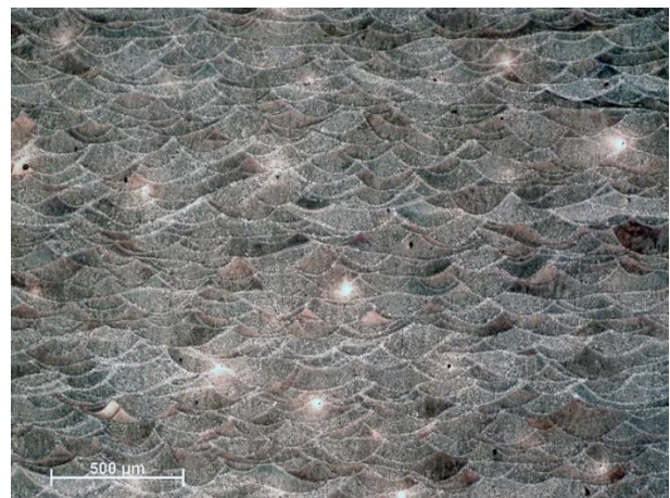
Figura 4. Micrografía óptica de la aleación Al10Si1Mg-FA realizada en el grupo CCRM-UCM.
