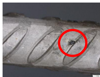
Figura 7. Detalle de la corrosión encontrada en la barra E11.
