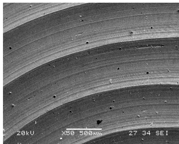
Figura 2. Referencia F51 Torneado x50.
