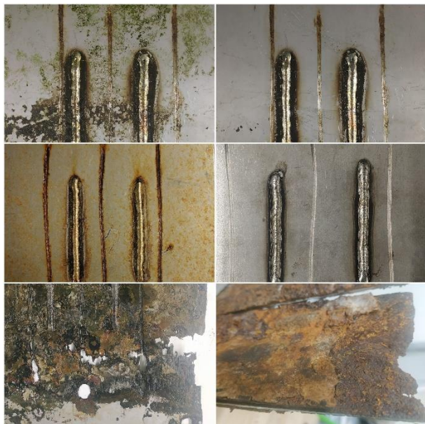
Figura 2. Recopilación de chapas: 304L ubicación 8 antes del primer lavado (a) y tras el último (b), 304L localización 1 (c), 2507 de la localización 5 tras lavados (d), 304L de la ubicación 6, completamente dañado, (e) y acero galvanizado de la zona 7 en proceso de corte (f).
