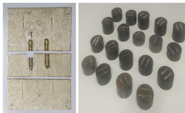
Figura 1. Esquema del corte de cada chapa, donde se utilizó la pieza central (a). Disposición de las muestras estudiadas (b).
