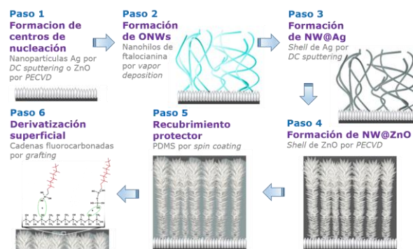
Figura 1. Síntesis de nanohilos piezoelectricos embutidos en PDMS. Estas estructuras serán la base de los nanogeneradores híbridos.
