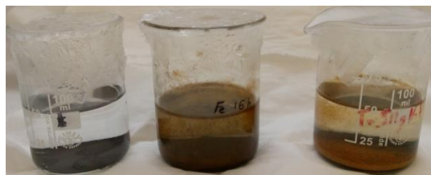
Figura 2. De izquierda a derecha, polvo de Fe sin moler, polvo de Fe molido 16h y polvo de Fe 5 Mg molido 16h tras 14 días del inicio del proceso de degradación.
