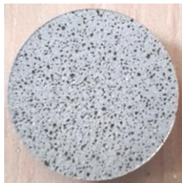
Figura 5. Espuma sinterizada de 60% de porosidad.
