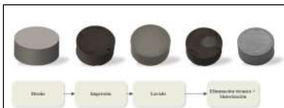
Figura 6. Esquema del proceso de fabricación solar.
