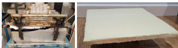
Figura 2. Molde cerrado calefactado (izq.) y ejemplo de probeta obtenida(der.).
