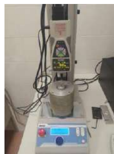
Figura 1. Banco de ensayo IMADA MX2 500N.
