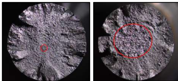
Figura 6. (a) Superficie de fractura de la probeta S1-x, (b) Superficie de fractura de la probeta S1-H2.
