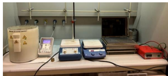
Figura 4. Equipo completo. De izquierda a derecha: el spin-coater y las tres placas.
