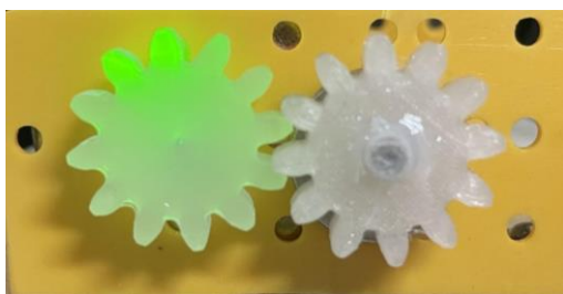
Figura 6. Fotografía del engranaje acoplado, excitando la rueda izquierda con un láser a 980 nm.
