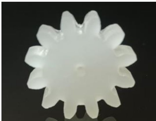
Figura 1. Rueda dentada impresa de mezcla resina – NaYF_4:Er, Yb .
