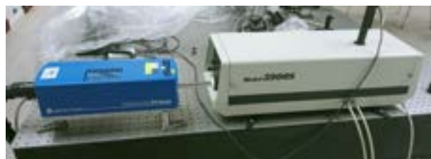
Figura 3. Láser de diodo DPSS a 532 nm bombeando un láser de Titanio-Zafiro sintonizado a 980 nm.
