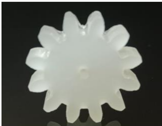
Figura 1. Rueda dentada impresa de mezcla resina – NaYF_4:Er,Yb .
