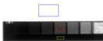
Figura 3. Ejemplo de análisis de la densidad relativa en una muestra de radiografía.
