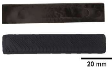
Figura 2. Probeta de flexión inyectada (arriba) e impresa (abajo) con un 0.25% de rGO.
