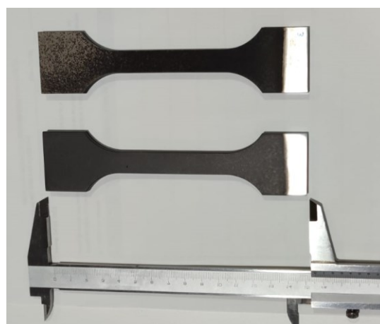
Figura 3. Probetas A3 (arriba) y A4 (abajo) anodizadas.
