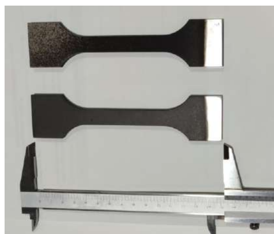
Figura 3. Probetas A3 (arriba) y A4 (abajo) anodizadas.
