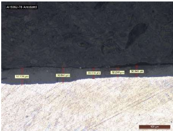
Figura 5. Medidas de espesor de la capa de óxidos por microscopía óptica.
