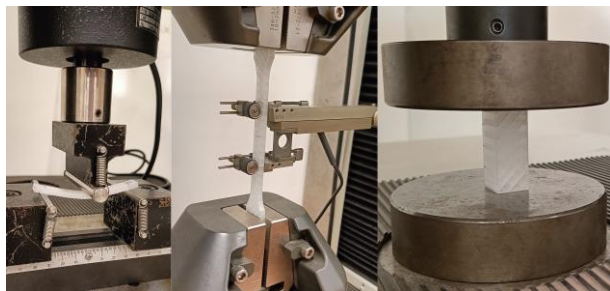
Figura 3. Ensayos mecánicos de flexión, tracción y compresión respectivamente.
