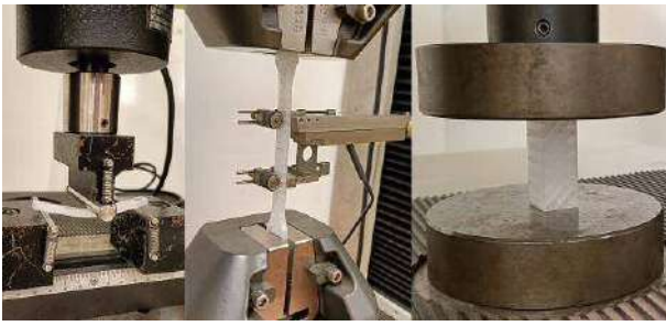
Figura 3. Ensayos mecánicos de flexión, tracción y compresión respectivamente.
