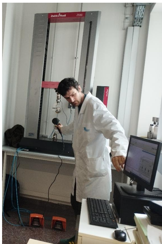
Figura 5. Experiencia de calentamiento de una muestra de elastómero estirado en una máquina de tracción.
