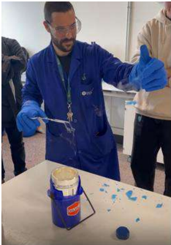
Figura 2. Demostración del cambio de propiedades de un guante de nitrilo, típicamente deformable a temperatura ambiente, pero se vuelve vítreo a bajas temperaturas sumergiéndolo en nitrógeno líquido.
